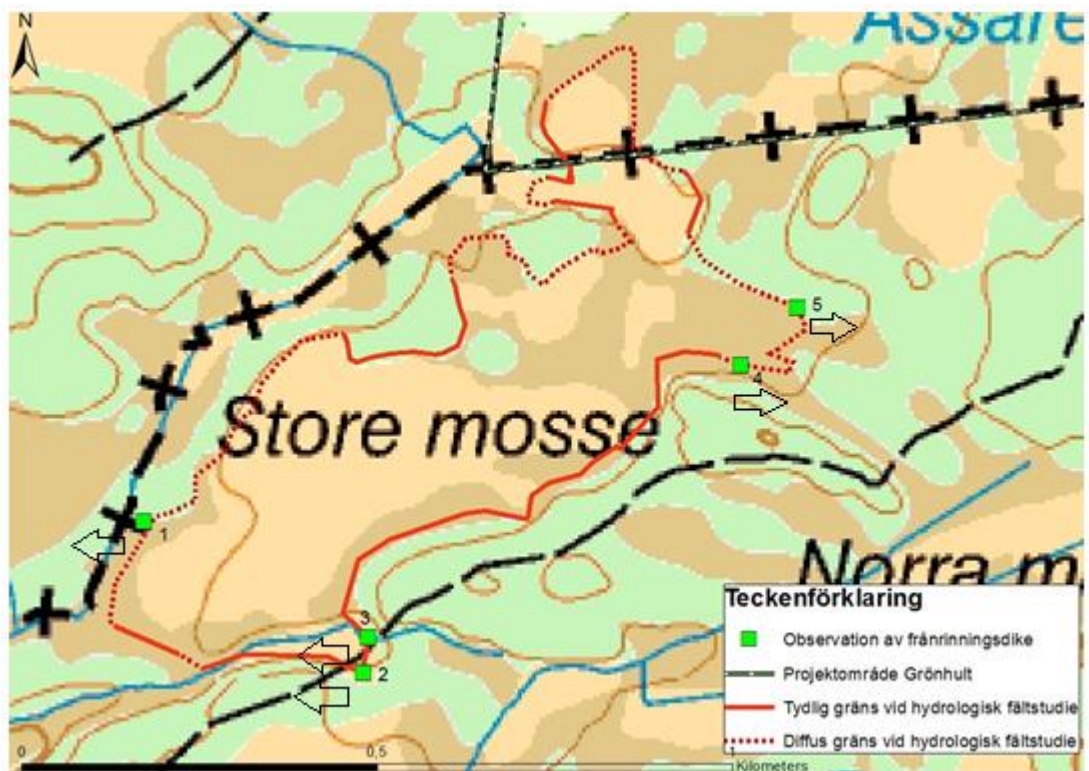
Figur 5 Hydrologiska fältobservationer samt flödesriktningar för diken.
