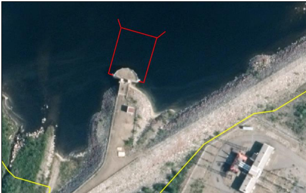
Figur 35. Principiell utformning nytt intag Blaisjön.
