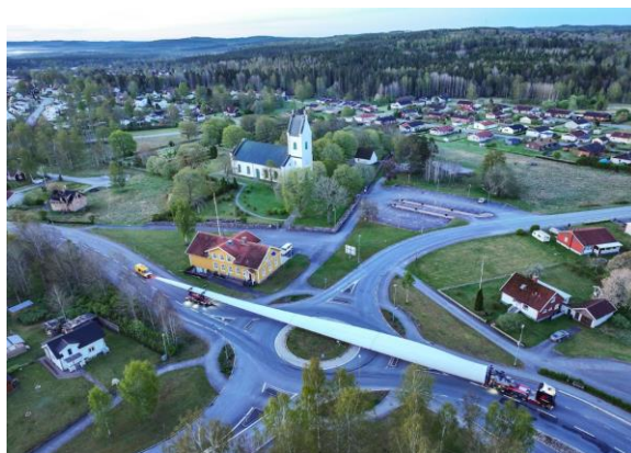
Transport av vindkraftblad genom Mariannelund. Specialtransporten med bladet är cirka 100 meter lång. Foto: Bengt Ljunggren, Grafica/Bengans Reklamtryck AB
