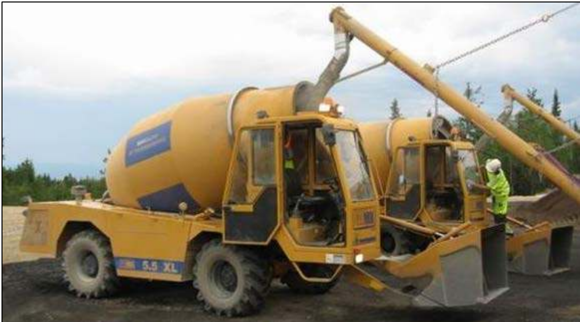
Figur 73. Mobil betongblandare. Foto: Vattenfall.
