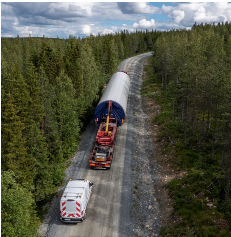
FIGUR 23 Transport av tornsektion på en relativt rak vägsträcka i Blakliden vindkraftpark. Inom vägområdet finns förutom vägen och dess slänter även diken och kabelschakt.
